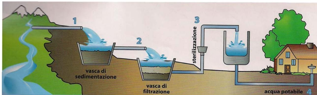
1. L'acqua prelevata dalla sorgente arriva nella vasca di sedimentazione dove le impurità solide (terriccio, sassi, ecc.) si depositano sul fondo.
